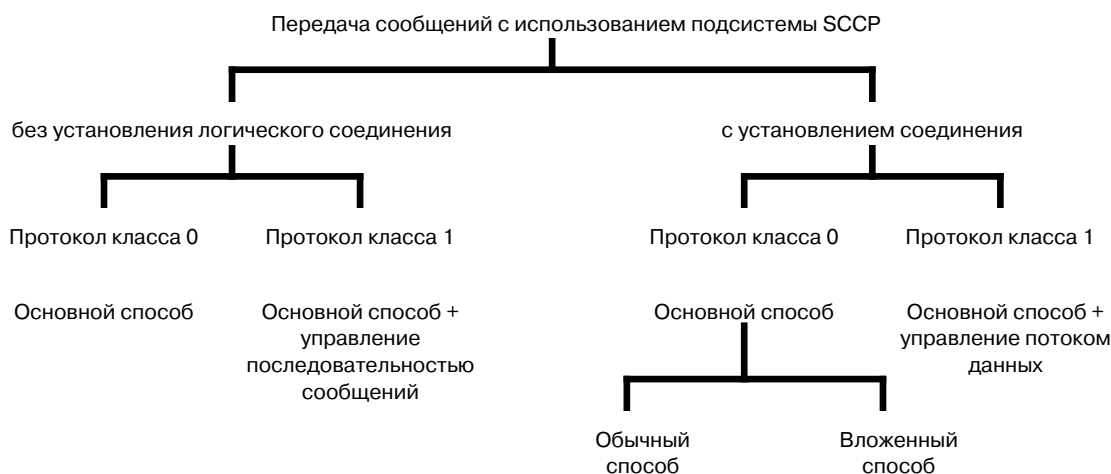
Рис. 3.13 Классы протокола для передачи сообщений через подсистему SCCP
